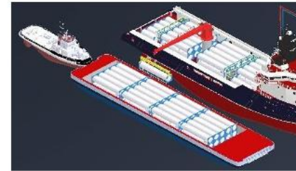
Transportschiff und Entladeschiff mit Stena Gas Interface Modul zur Entladung auf See (Quelle: Stena LNG Studie vorgestellt beim BMWK)
